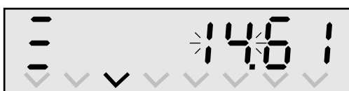
Рисунок 44 Ввод значения константы для канала измерения давления
