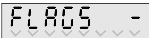
Рисунок 38 Пункт просмотра аварийных флагов
